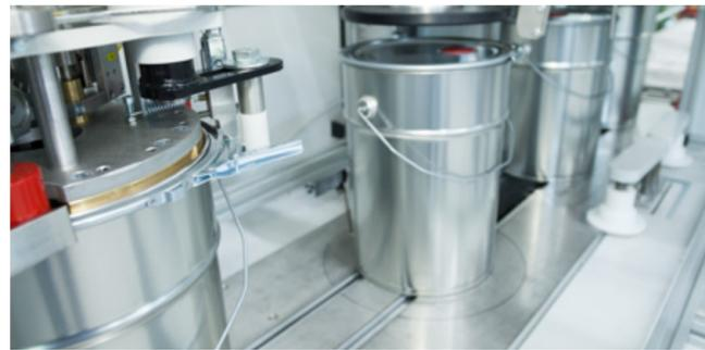
FlexoClose ist die neue Generation von Verschließmaschinen für mittlere und große Industrieverpackungen aus Weißblech (2,5 – 33,0 Liter) mit Spannringverschluss. Mit nur einer Anlage verschließen Sie bis zu fünf Gebindedurchmesser, dies wird ermöglicht durch ein modular aufgebautes, variables System.
